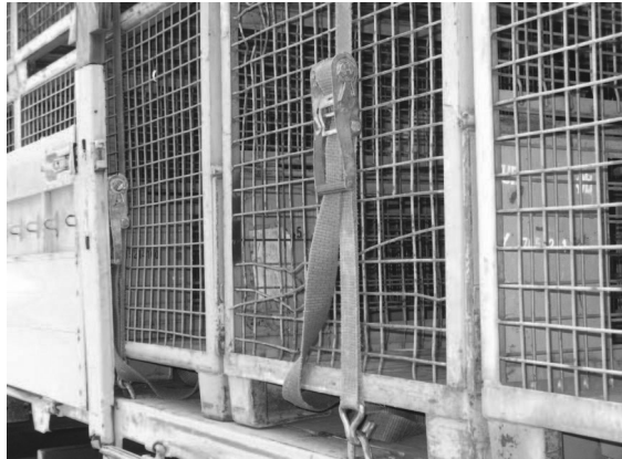
Abb. 5.4.5-8: Beispielhafte Kombination von form- und kraftschlüssiger Ladungssicherung (mit zusätzlicher kraftschlüssiger Sicherung der oberen Palettenreihe)
