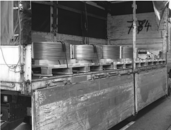
Abb. 5.4.5-4: Praktisches Beispiel einer formschlüssig verstaute Ladung.
