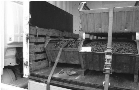
Abb. 5.4.5-7: Niederrinnen in der Praxis am Beispiel der Metallbehälter (in formschlüssiger Abstützung an der Stirnwand)
