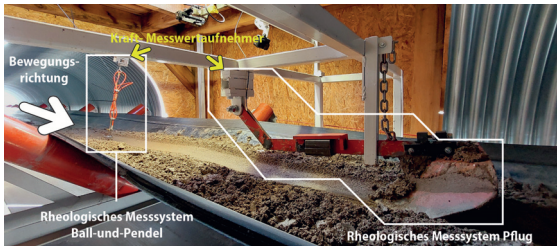
Abb. 6.1.9-9: Konstruierte Vorrichtung, bestehend aus Pflug- und Pendel-system mit jeweils Zugkraftsensor, zunächst am Testförderband installiert und getestet. Die Förderbandbewegung ist von links nach rechts (Quelle: Budach in Anlehnung an Thienert et al., 2025 1 )
