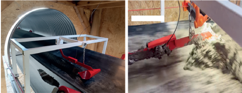
Abb. 6.1.9-5: Pflugsystem mit Kraftsensor vor der Datenerfassung (links) und im Betrieb (rechts) 1 (Quelle: Herrenknecht AG)
