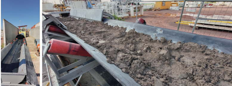
Abb. 6.1.9-4: Testförderband im Maßstab 1:1 bei der Herrenknecht AG ohne (links) und mit Boden auf dem Förderband (rechts) 1 (Quelle: Herrenknecht AG)
