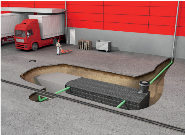
Bild 2: Rigolenversickerung mit Fertigteilen aus Kunststoff (Quelle: Otto Graf GmbH)
