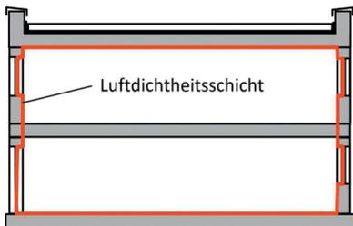
**Bild 2:** Stiftregel: Zeichnen der Luftdichtheitsschicht ohne diesen abzusetzen (nach DIN 4108-7, Bild 1) (Quelle: Schmiadt)
