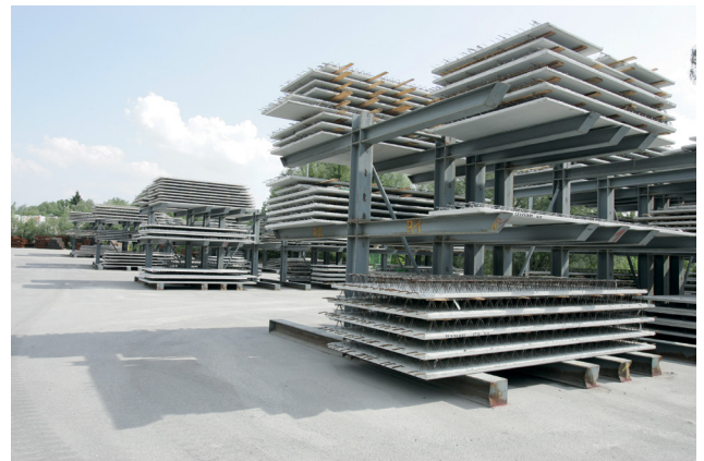
Bild 2: Elementdecken fertig für den Transport zur Baustelle (Quelle: RBW Rohrdorfer Betonwerk)
