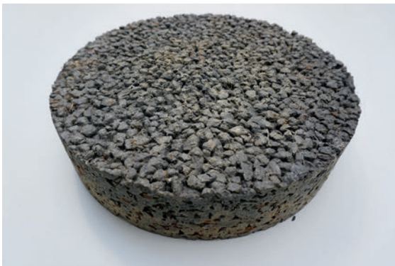
Abb. 5.4.2.2-2: Probekörper Dränbetondecke DBD 5/8 (Quelle: Riffel)
