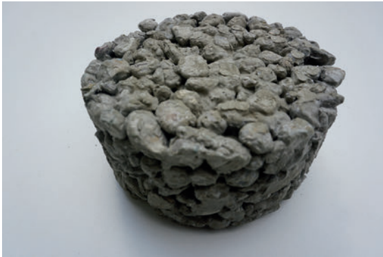
Abb. 5.4.2.2-1: Probekörper Dränbetontragschicht DBT 8/16 (Quelle: Riffel)
