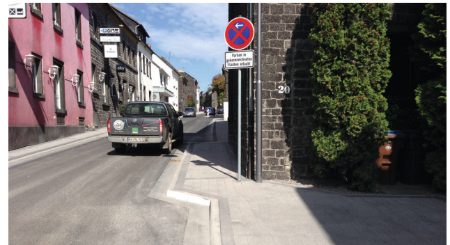
Bild 7: Durchgängige Mindestgehwegbreite an einer Engstelle im Zuge einer Ortsdurchfahrt (Quelle: Boenke)
