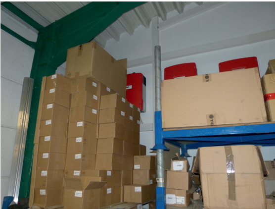
Abb. 3.7-7: Lagerraum (=feuergefährdete Betriebsstätte) mit brennbaren Materialien, Quelle: SV Schröder
