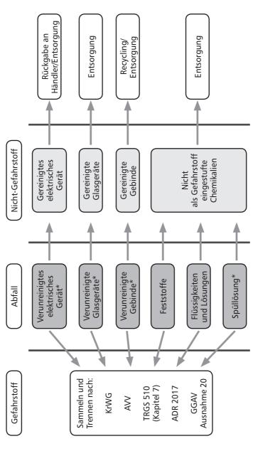
Reinigung nicht möglich, so wird der Abfall entsprechend den gesetzlichen Vorgaben als Gefahrstoffabfall behandelt und entsorgt. Die Prozesse, bei denen verunreinigte Spüllösung anfällt, sind mit einem Stern gekennzeichnet. \* Anfallender Abfall, der mit Gefahrstoffen verunreinigt ist, wird gereinigt und kann dann als ungefährlicher Abfall entsorgt werden. Ist eine
